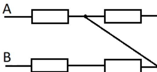
Определите сопротивление всей схемы между точками A и B. Сопротивление соединительных проводов пренебрежимо мало.
