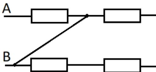
Определите сопротивление всей схемы между точками  $A$  и  $B$ . Сопротивление соединительных проводов пренебрежимо мало.
